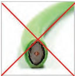
Schnitt mit Seitenschneider
