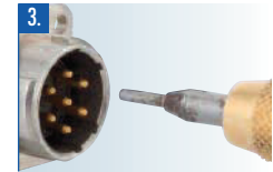
Demontage der Kontakte 3. Den Träger Nr. 1 oder Nr. 3 vor dem Geräte- oder Kabelsteckverbinder je nach verwendetem Träger in der Achse der Buchse oder des Stiftes positionieren. Anschließend einen axialen Druck ausüben, bis der Stift oder die Buchse vom Isolierkörper gelöst ist.
