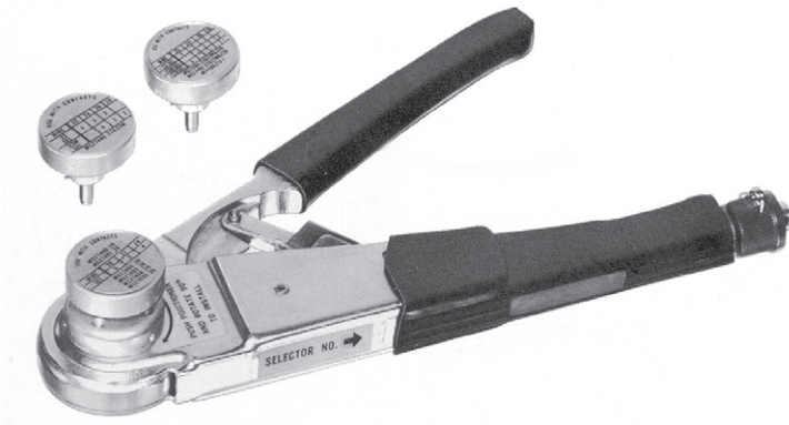
Crimp-Zange M 22520/2-01 (8-Kerb-Crimpverbindung)
