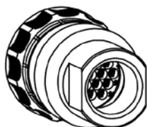
5. Beispiel: Endgehäuse verkleinert, mit Schlüsselfläche versehen
